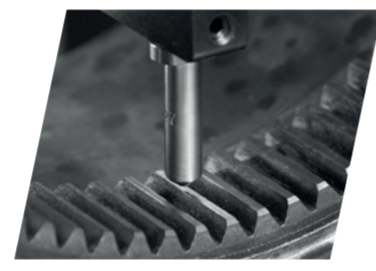
Qsolution INTEST Sonderlösung für eine normgerechte Härteprüfung mit optischer Bildauswertung an schwer zugänglichen Prüfstellen
