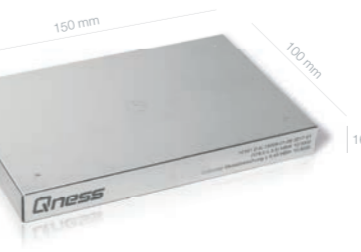
BRINELL DIN EN ISO 6506-3, ASTM E10 HBW 10/500 / HBW 10/1000 / HBW 10/1500 / HBW 10/3000 HBW 5/125 / HBW 5/250 / HBW 5/750 / HBW 2,5/31,25 / HBW 2,5/62,5 HBW 2,5/187,5 / HBW 1/5 / HBW 1/10 / HBW 1/30
